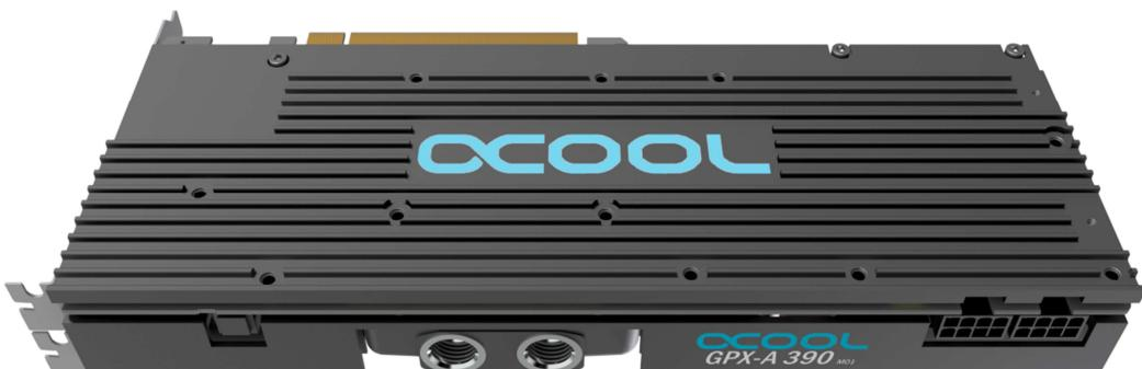
Legen Sie die Backplate wie in dem Bild gezeigt auf die Grafikkarte. Ein leichter Druck sorgt für den optimalen Kontakt zwischen Backplate, Kühler und Grafikkarte.
