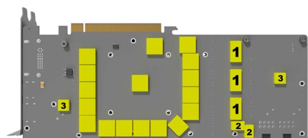
Entfernen Sie die Schutzfolie der gelb dargestellten 15 mm x 15 mm x 3 mm-Wärmeleitpads und legen Sie diese auf die Rückseite der Speicherbausteine. Schneiden Sie die übrigen, gelb dargestellten Wärmeleitpads entsprechend der Schnittmustervorlage zu. Diese werden auf die Rückseite der Spannungswandler und der GPU gelegt. Vergessen Sie auch hier nicht die Schutzfolie zu entfernen.
