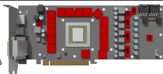
Entfernen Sie die Schutzfolie der rot dargestellten 15 mm x 15 mm x 1,5 mm Wärmeleipads und legen Sie diese auf die Speicherbausteine. Die übrigen, roten Wärmeleipads für die Spannungswandler müssen zugeschnitten werden. Die genauen Maße entnehmen Sie bitte der Schnittmustervorlage, am Ende der Anleitung. Platzieren Sie die Pads, wie dargestellt. Vergessen Sie auch hier nicht die Schutzfolien zu entfernen.
