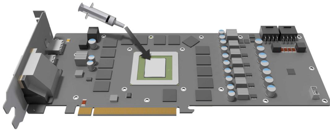
Tragen Sie nun unter Zuhilfenahme eines Plastikstreifens oder Ähnlichem, eine gleichmäßige Schicht Wärmeleitpaste auf die zu kühlenden GPU auf. Die Schicht sollte weniger als einen Millimeter dick sein, da sonst die umliegenden Bauteile unnötig verunreinigt werden können.
