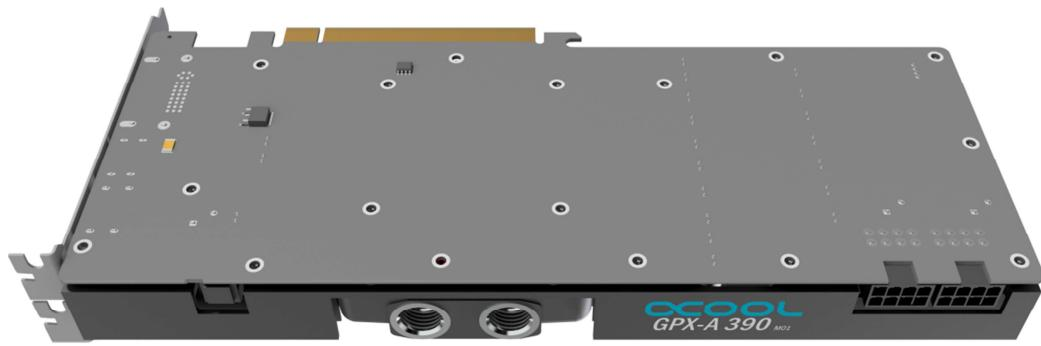
Montieren Sie nun den zusammengesetzten Kühler auf die Grafikkarte. Falls eine Schutzfolie auf dem Kühlerboden vorhanden ist, entfernen Sie bitte jetzt die Schutzfolie. Reinigen Sie die Kontaktflächen auf der Bodenseite des Kühlers mit Spiritus oder ähnlichen Mitteln. Die Fläche muss frei von Verunreinigungen sein.
